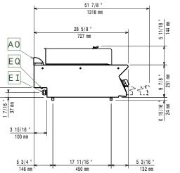
Electrical inlet (power) EQ **Equipotential screw**
